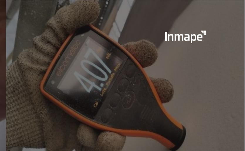
**23** Los espesores de película seca deben ser medidos después de 4 horas a 25°C.
